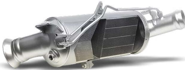
**Este sistema se implanta en vehículos con el filtro de partículas alejado del motor.** Debido al largo recorrido de los gases escape entre el motor y el filtro de partículas, **la temperatura de encendido necesaria para la combustión de las partículas sólo se puede alcanzar agregando un aditivo.**
