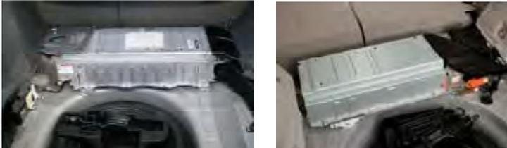
Las distintas baterías utilizadas en las tres generaciones del Toyota Prius son semejantes en cuanto a su disposición, diferenciándose principalmente en la tensión proporcionada. Mientras que la primera generación la tensión nominal de la batería HV es de 273,6 V, en la segunda y tercera generación la tensión nominal que suministran es de 201,6 V.
