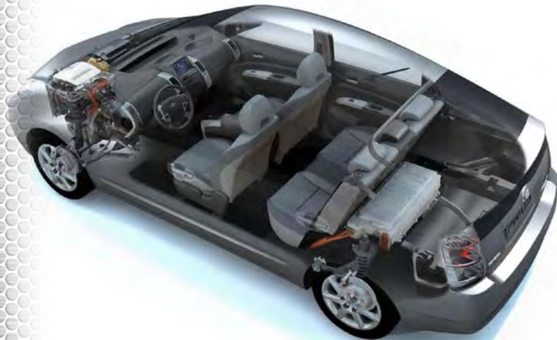
La batería está constituida por una serie de módulos divididos cada uno de ellos en 6 células de 1,2 voltios. La batería HV del Prius I tiene 38 módulos de 7,2 V cada uno de ellos, por lo que su tensión nominal es de 273,6 V.
